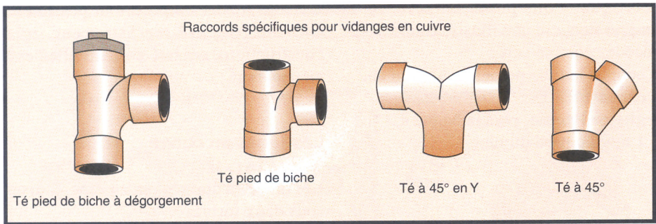
Figure 101 : Les raccords à braser
